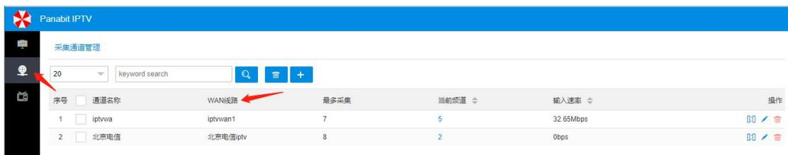
**注意：**通道中有个最大采集的设置，一般情况下，一个光猫口是最多支持 8 个频道同时播放，如果超过了，则运营商会关闭该口的所有频道，为了避免使用者计算和误操作，故加入了最大采集的设置，这样能够有效避免频道被运营商关闭的风险；
